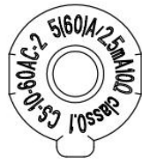
打标内容: CS-10-60AC-2 5(60)A/2.5mA 10Ω class0.1
